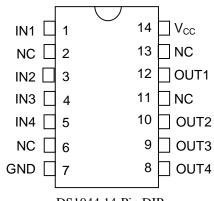
DS1044 14-Pin DIP DS1044R 14-Pin SOIC (150-mil) See Mech. Drawings Section
