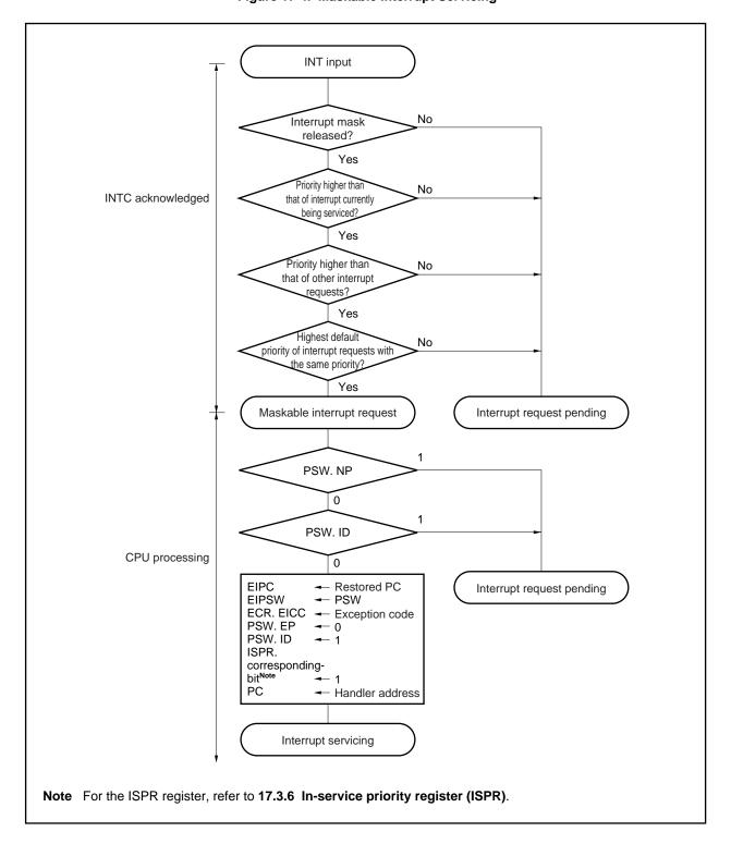
Figure 17-4. Maskable Interrupt Servicing
