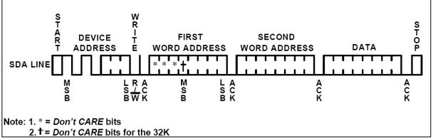
Figure 8 · Byte Write
