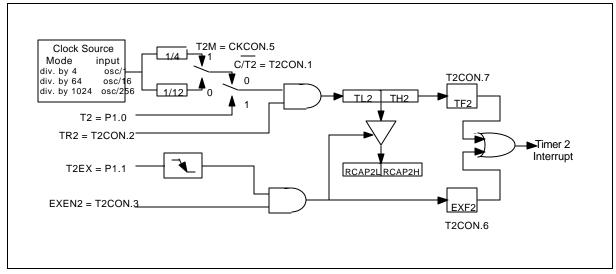
Figure 14. 16-Bit Capture Mode
