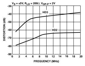
FIGURE 12. HARMONIC DISTORTION vs FREQUENCY
