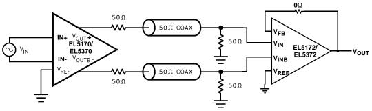
FIGURE 21. DUAL COAXIAL CABLE DRIVER
