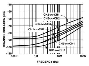
FIGURE 9. CHANNEL ISOLATION vs FREQUENCY
