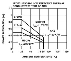
FIGURE 18. PACKAGE POWER DISSIPATION vs AMBIENT TEMPERATURE
