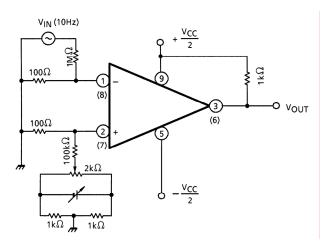
$$G_V = 20 \ \ell \ og \ \frac{V_{OUT}}{V_{IN}} + 80 \ (dB)$$
