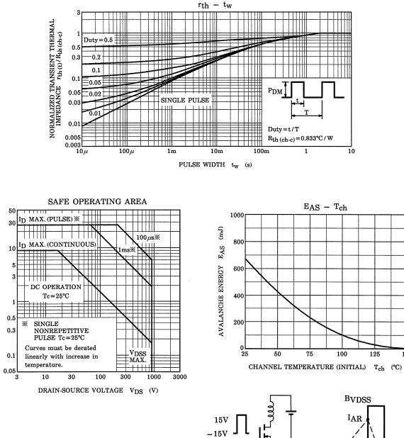
15V I I I AR 15V VDD VDS TEST CIRCUIT WAVE FORM
