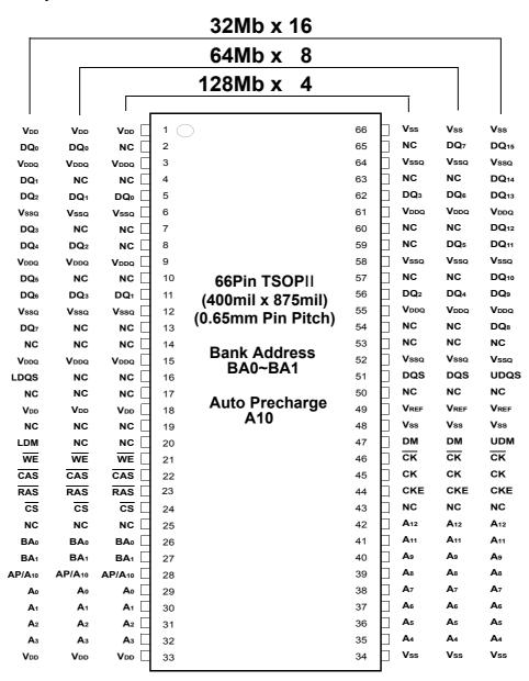
512Mb TSOP-II Package Pinout
