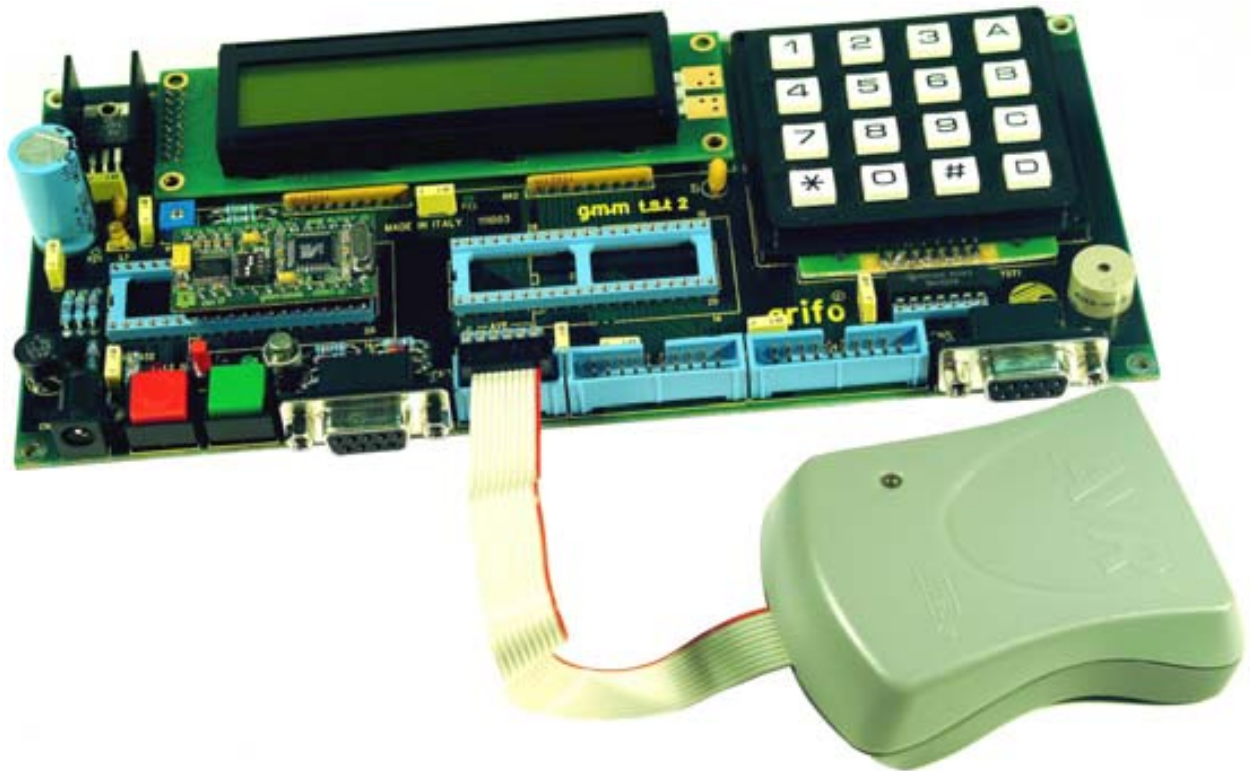
FIGURA 12: SCHEDA DI SPERIMENTAZIONE GMM TST 2 CON GMM AM08 E AVR ISP
