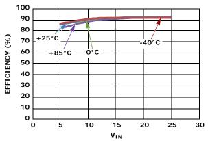
FIGURE 7. EFFICIENCY vs V<sub>IN</sub> vs TEMPERATURE AT 20mA (100% LED DUTY CYCLE)
