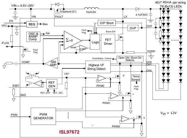
FIGURE 2. ISL97672 BLOCK DIAGRAM
