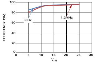
FIGURE 6. EFFICIENCY vs V<sub>IN</sub> vs SWITCHING FREQUENCY AT 30mA (100% LED DUTY CYCLE)
