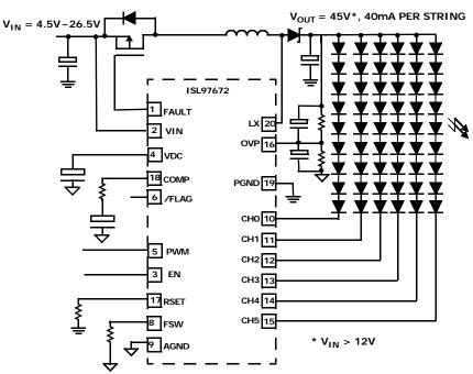
FIGURE 1. ISL97672 TYPICAL APPLICATION DIAGRAM
