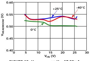
FIGURE 10. V<sub>HEADROOM</sub> vs V<sub>IN</sub> AT 20mA
