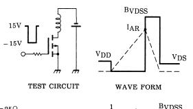
$\begin{array}{l} R_{\rm G} \!=\! 25\Omega \\ V_{\rm DD} \!=\! -50V, \ L \!=\! 747 \mu \mathrm{H} \end{array}$
