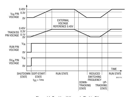
Figure 14. Tracking if V<sub>SRLIM</sub> Is Tied to SV<sub>IN</sub>
