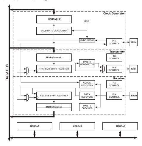
Figure 19-1. USART Block Diagram<sup>(1)</sup>
