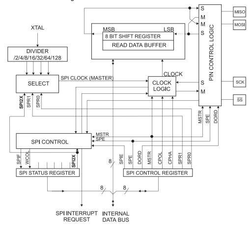
Figure 18-1. SPI Block Diagram<sup>(1)</sup>
