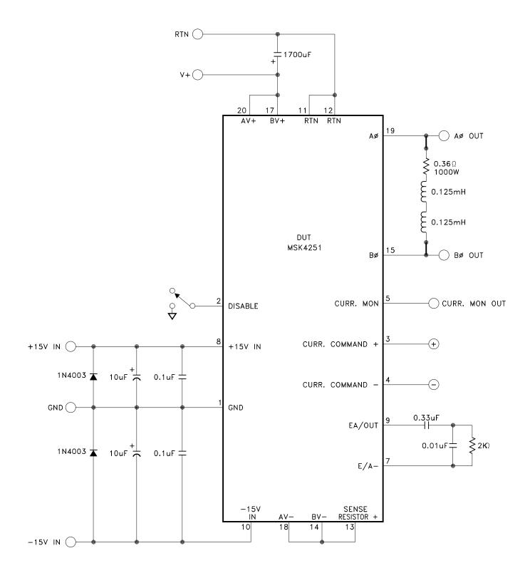
TYPICAL TEST SCHEMATIC
