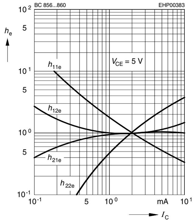
**h parameter  $h_e = f(V_{\text{CE}})$  normalized**
