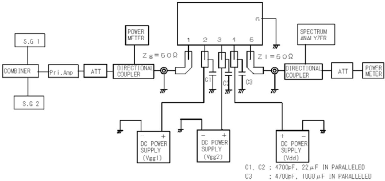
TEST BLOCK DIAGRAM (SINGLE CARRIER)
