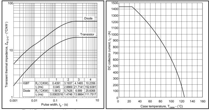
Fig. 11 Transient thermal impedance
