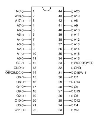
A0 - A20 : Address inputs O0 - 07, O8 - O14 : Data outputs
